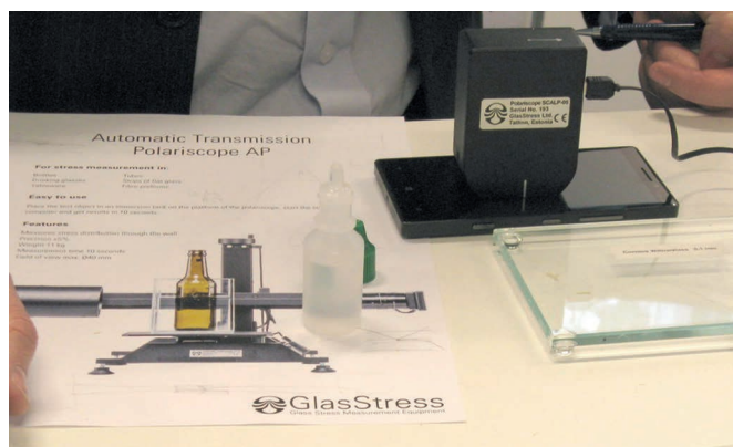
8. ábra Üvegek vastagság menti feszültség eloszlásának mérésére alkalmas SCALP-04 készülék
