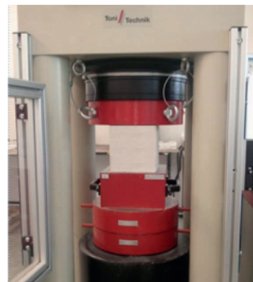
Fig. 3. Determination of 3-point bending tensile strength (a) and compressive strength (b) 3. ábra. Harmadpontos hajlítóvizsgálat elrendezése (a) és nyomószilárdság vizsgálat (b)
