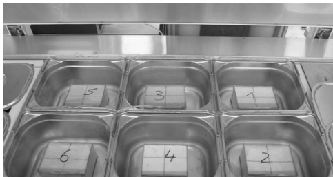
Fig. 4. Determination of the capillary suction of de-icing solution and freeze thaw test 4. ábra. Kapilláris sóoldat felszívás és fagyhámítás vizsgálata
