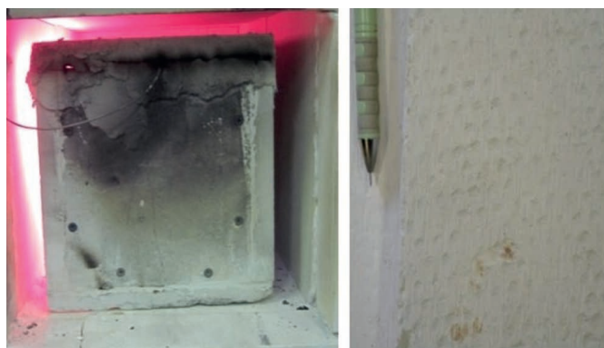
7. ábra A gipszrost próbadoz 132 perc után
