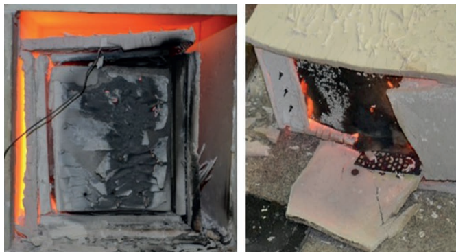
5. ábra A tűzálló gipszkarton próbadoz 144 perc után
