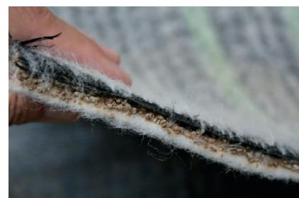
8. ábra Voltex bentonitos paplanszigetelés szerkezete [8]
