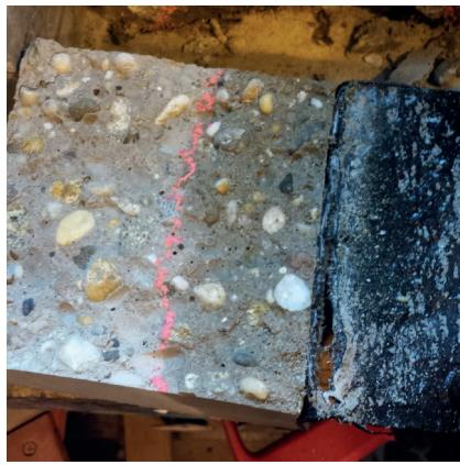
14. ábra A sérült szigetelésen átjutó víz képe a hasított próbatesten laterális vízvándorlás esetén
