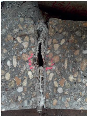
13. ábra A sérült szigetelésen átjutó víz képe a hasított próbatesten amikor nincs vízvándorlás
