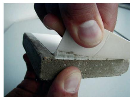
3. ábra A Preprufe 300R vízszigetelő lemez felépítése [4]
