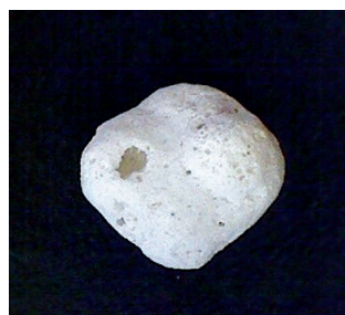
6. ábra Duzzasztott üvegkavics nyílt pórusokkal, hőszigetelő és teherhordó könnyűbetonokhoz Fig. 6. Expanded glass aggregate with open pores for thermal insulating and load bearing applications
