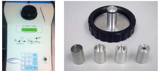
Fig. 3. Quantachrome 1200e type densitometer (left) and measuring cells (right) 3. ábra Quantachrome 1200e típusú sűrűségmérő berendezés (balra) és a hozzá tartozó mérőcellák (jobbra)
