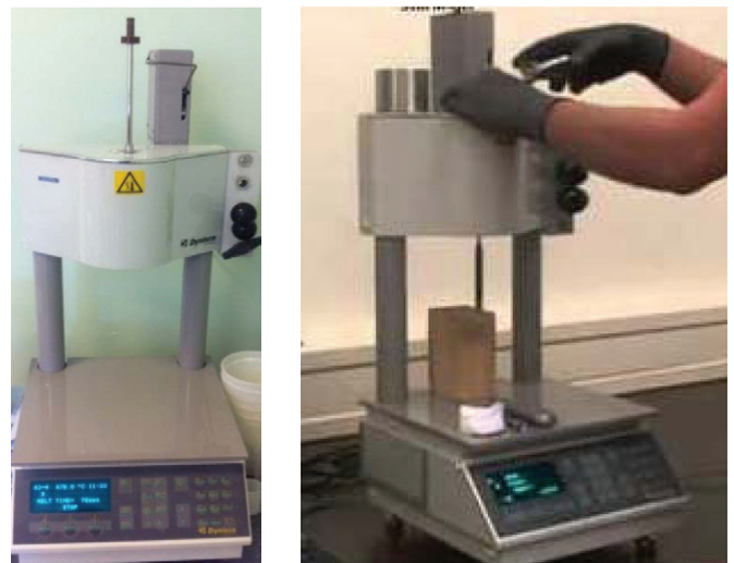
Fig. 5. Dynisco capillary rheometer (left) and the viscosity measurement of feedstock (right) 5. ábra Dynisco kapilláris viszkoziméter (balra) és a feedstock viszkozitás mérése (jobbra)
