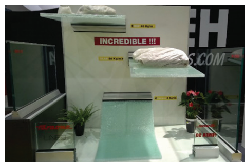
15. ábra Előtető üvegzésének tönkremenetelt követő viselkedése a különféle lamináló fóliák hatására (legfelül: SGP+40 kg/m, közepén: XLAB+80 kg/m, alul: szokványos fóliák). Fig. 15. Post fracture behaviour of glass canopy with use of different interlayer foils (in the top: SGP+40 kg/m, in the middle: XLAB+80 kg/m, in the bottom: conventional foils)
