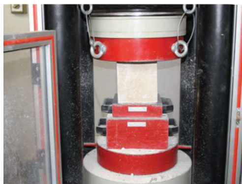
Fig. 4. Compressive strength testing 4. ábra Nyomószilárdság vizsgálata
