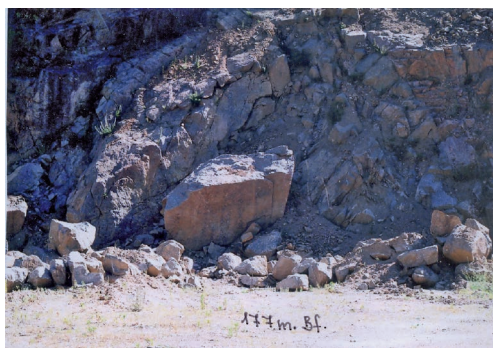
17. ábra Bányafal omlás a 177 méteres szint (Bf.) északnyugati falszakaszán. A tetemes gránittömb mérete meghaladta a 11 m 3 -t Fig. 17. Pit wall collapse at the North-West section of the 177 m.Bf. extracting bench; large granite block of volume over 11 m 3
