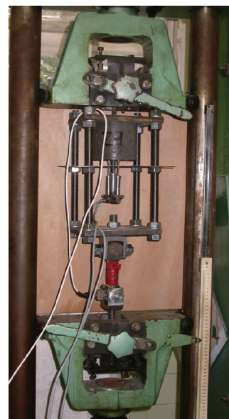
4. ábra Az alkalmazott acélkeret a kihúzáshoz Fig. 4. Loading frame for the pull-out tests
