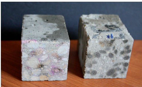
1. ábra Próbatestek a koptató vizsgálat után Fig. 1. Specimens after the abrasion test
