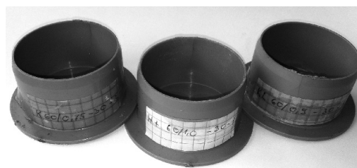
2. ábra Próbatestek zsaluzata Fig. 2. Specimens formwork
