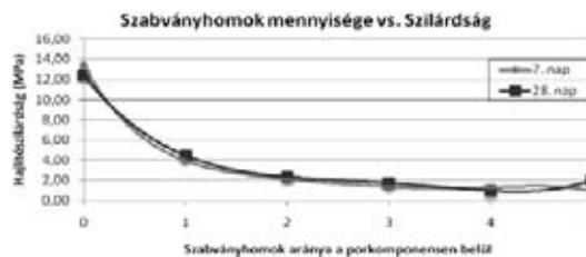
3. ábra A hajlítószilárdság változása a szabványhomok mennyiségének függvényében Fig. 3. The change of the flexural strength in the function of the quantity of the standard sand
