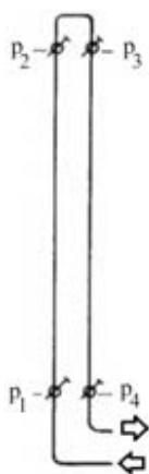
4. ábra A szállítási koncentráció mérése 4 db nyomás távadóval Fig. 4. Measurement of the transport concentration by 4 pressure transducers
