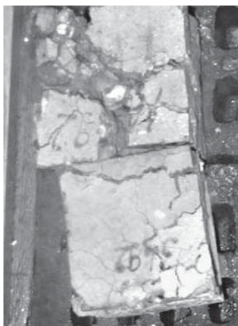
6. ábra 900 °C-ról vízköddel hűtött próbatest Fig. 6. Specimens heated at 900 °C cooled with water mist
