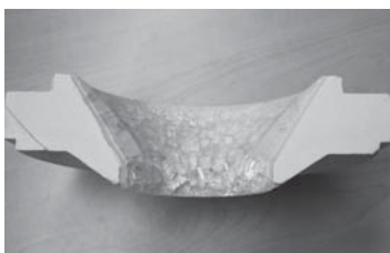
3b. ábra Quarzal® cseppgyűrű 12 heti használat után Fig. 3b. Quarzal® drop-ring after 12 weeks of use
