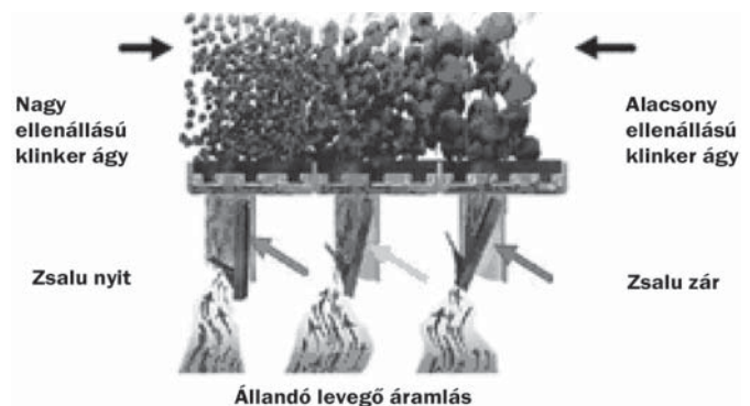
4. ábra Levegő aláfúvás szabályozása a klinkerágy ellenállás függvényében (KHD)
