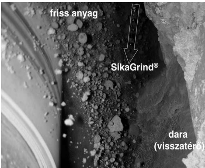
1. ábra A cement malomba friss anyagot, darát (visszatérő) és SikaGrind®-et adagolnak Fig. 1. Total feed of cement mill consisting of fresh material, the return from the separator and SikaGrind
