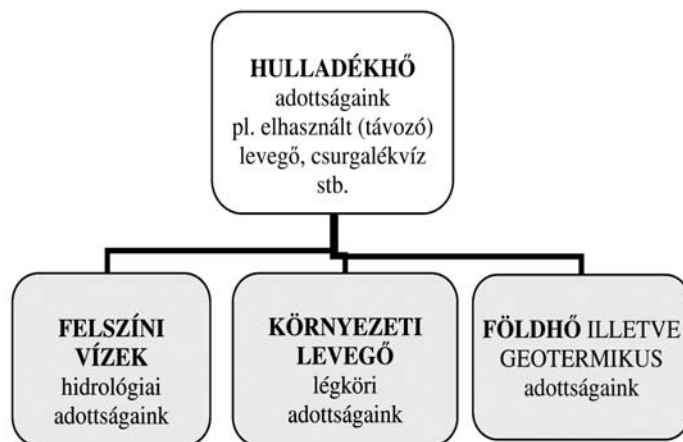
8. ábra A hőszivattyú hőforrásainak (az ún. zöldhőnek) csoportosítása Fig. 8. Classification of heat resources (the so called 'green heat') of the heat pump
