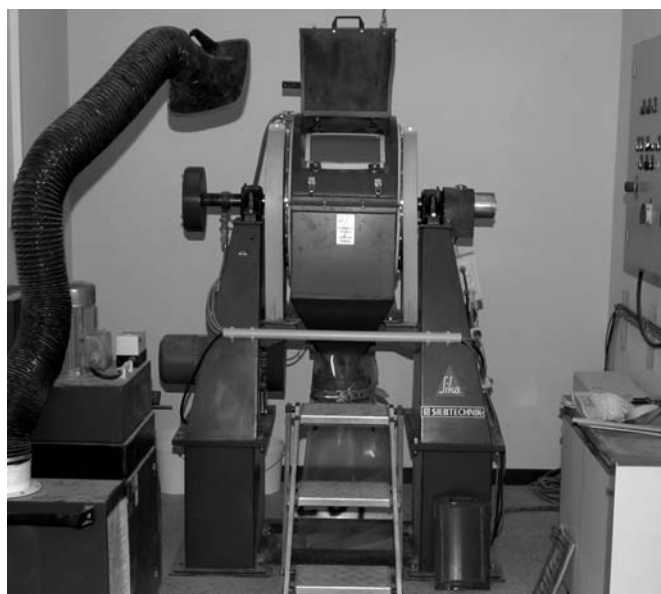
6. ábra A golyós malom mellett a Sika központi cement laboratóriuma fel van szerelve minden szükséges eszközzel Fig. 6. In addition to the ball mill, Sika's central cement laboratory is equipped with all the necessary tools to provide support
