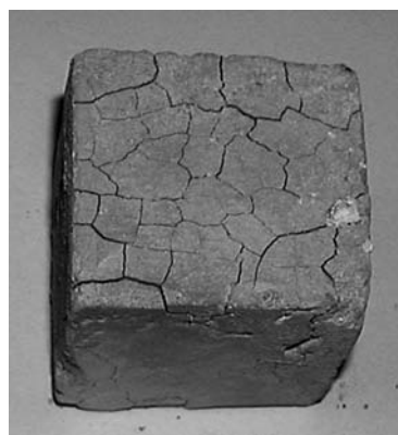
2. ábra A mészkő tartalmú próbatestek felületi repedésképe három nappal a 800 °C-os hőterhelés és lehűlés után Figure 2. The development of surface cracks in case of limestone additive three days after the temperature loading with 800 °C
