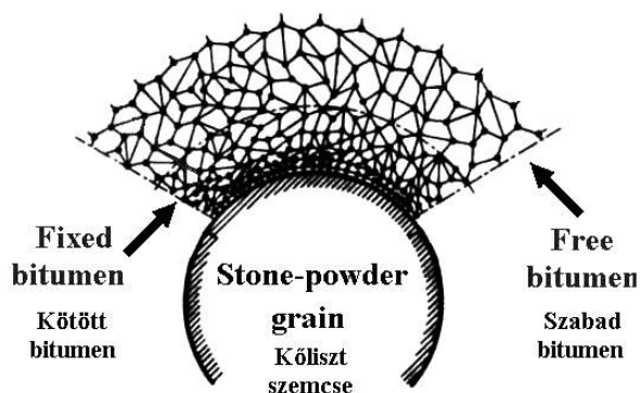
1. ábra. Diffúziós bitumenhártya kialakulása a kőliszt szemcse felületén Fig. 1. The formation of diffusion bitumenfilm on the surface of stone-powder grain (átvéve: L. B. Gezencvej: Aszfaltbeton útburkolatok [4.])
