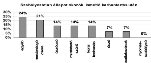
11. ábra. Hibaokok Pareto diagramja, módosítás után Fig. 11. Pareto diagram by defective items after modification
