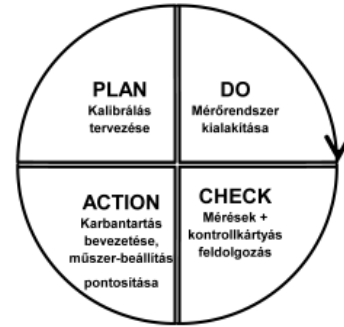
14. ábra. Kalibrálás kialakításának PDCA módszere Fig. 14. Calibration using PDCA
