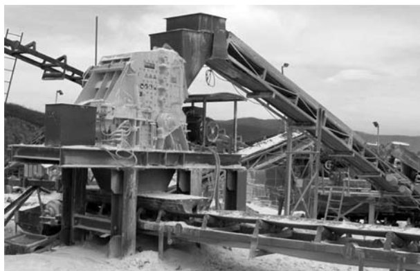
2. ábra. Az egyik vizsgált röpítőtoró és szállítószalag-rendszere One of the investigated crushers and its belt-conveyor system
