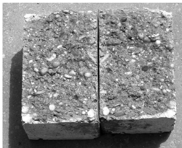
2. ábra. E1 egykomponensű szárazhabarcs bevonat hatása a C2 jelű beton vízzáróságára
