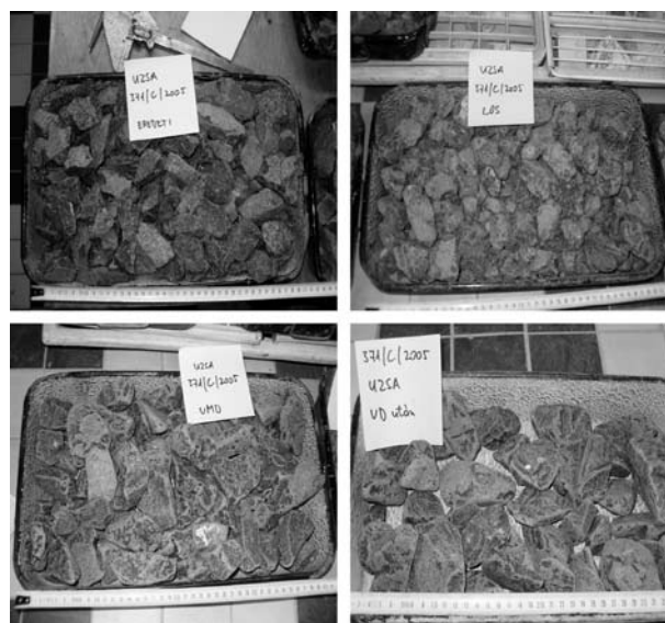
7. ábra. Bazalt (Uzsa) vasúti ágyazati kőanyag jellemző képe vizsgálat előtt, Los Angeles-, vasúti mikro-Deval- és vizes Deval-vizsgálat után Properties of basalt aggregates (Uzsa) before and after Los Angeles-, micro-Deval and Deval test
