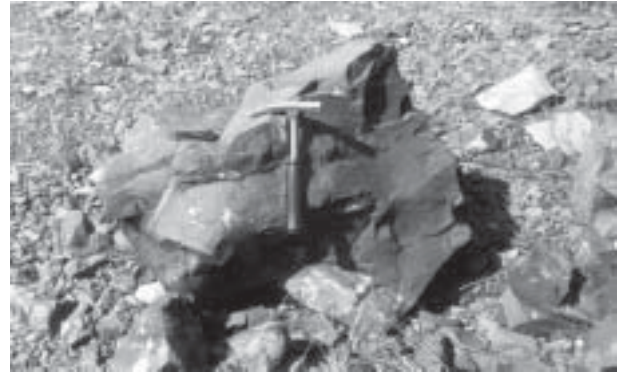
12. ábra. Felső szint, északkeleti bányafal felső részén levő, szabálytalan síkok mentén elváló bazalt
