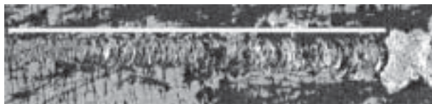
4. ábra. SEM-felvétel egy karcnyomról a károsodás kezdetéig, a jelzett szakasz 1,82 mm
