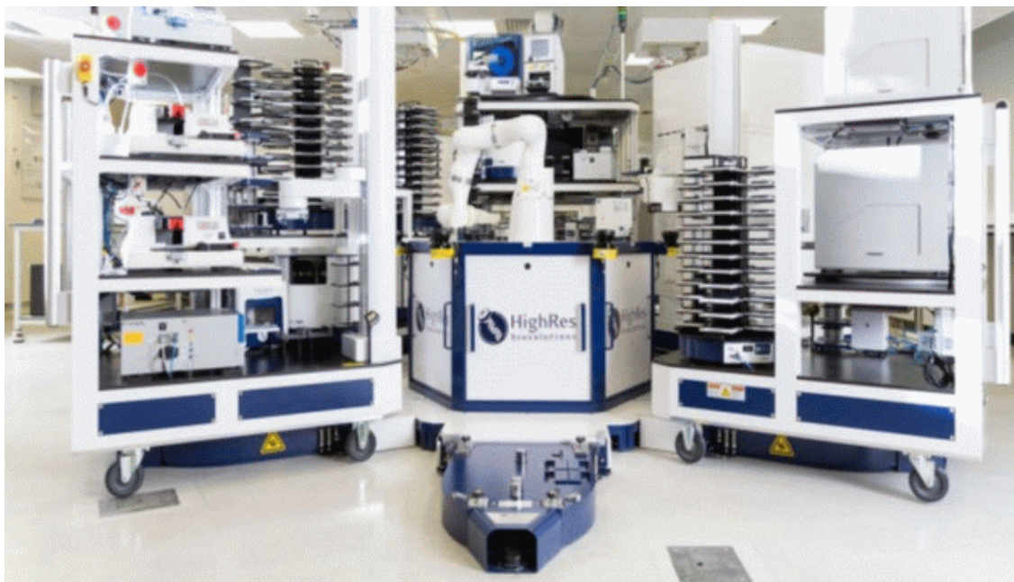
2. ábra. iLab multifunkciós robot az AstraZeneca mölndali kutatóközpontjában. (Forrás: AstraZeneca.)
