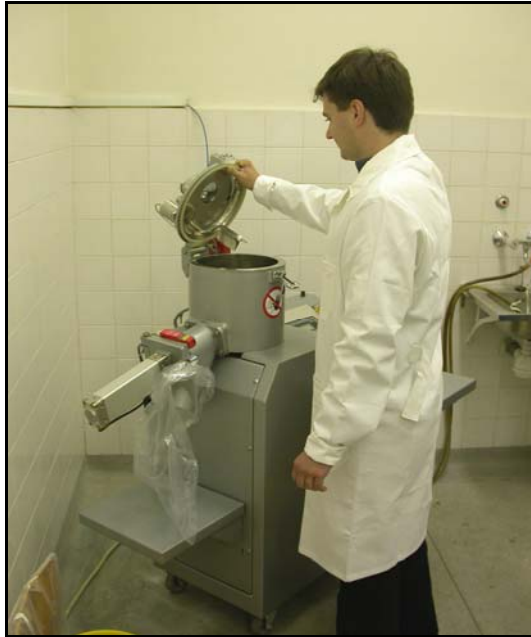
Polimer porok és adalékanyagok homogenizálása gyorskeverővel
