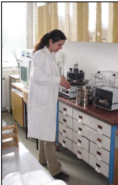
A minta előkészítése és behelyezése a Pirolízis – GC – MS berendezésbe
