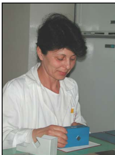
Festett mintadarab fényességvizsgálata
