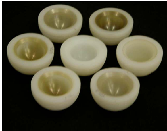
Kezeletlen (középen) és PIII kezelt polietilén csípőízületi vápák
