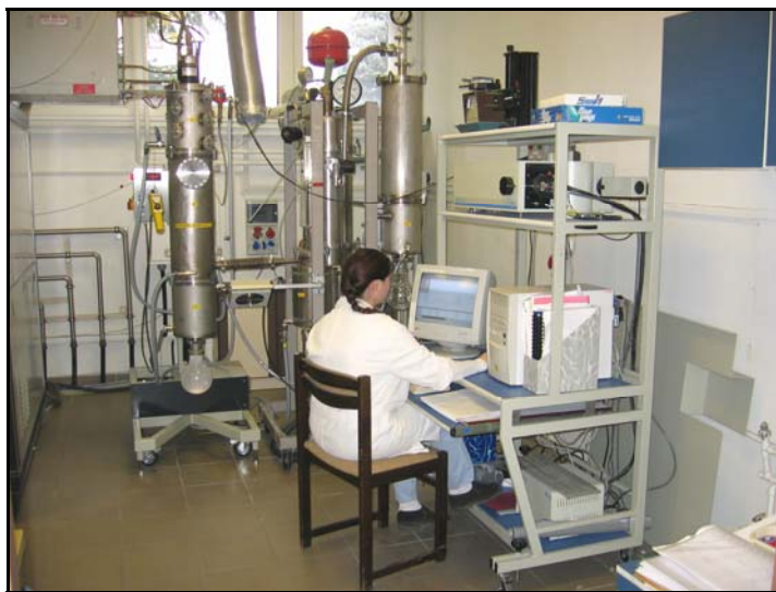
A plazmaláng hőmérsékletének mérése száloptikás emissziós spektrométerrel
