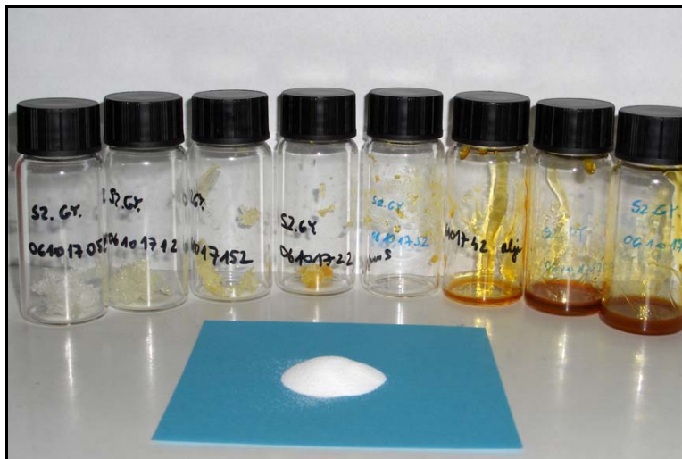
Termooxidatív lebontással kapott olajszerű, oxidált PVC
