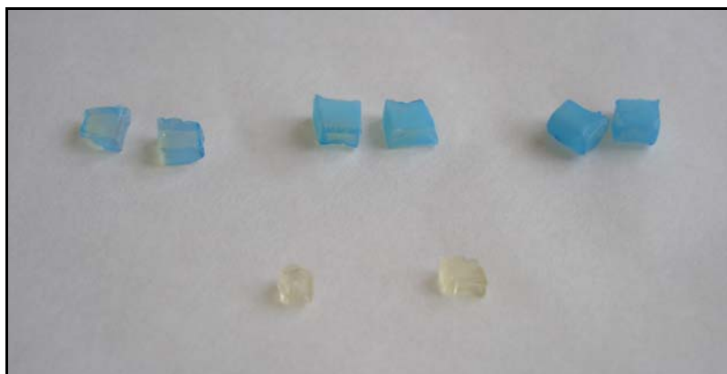
A poli(N-vinil-imidazol)-l-poli(propilén-oxid) kotérhálóból készített eredeti (átlátszó), illetve \text{Cu}^{2+} -ionokat tartalmazó (kék színű) minták
