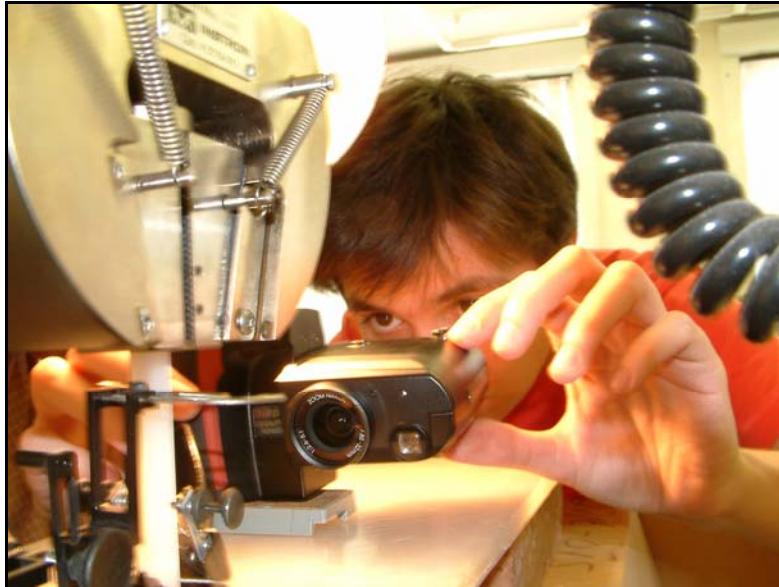
Akusztikus emisszió mérése polimerek húzóvizsgálata során
