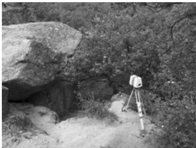
2. kép A Leica C10 lézerszkennerek az Osztott-barlang délkeleti bejáratánál (Forrás: Nagy Gábor) Picture.2. The Leica C10 laser scanner on the southeast entrance of the Osztott-cave (Source: Gabor Nagy)
