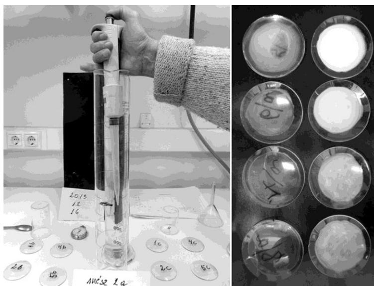
1. kép: A pipettás módszer és szárazanyag tartalom Picture 1.: The pipette method and dry matter content
