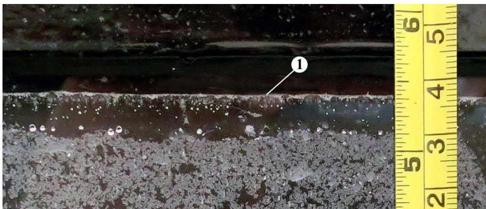
2. kép: Vonalas bevonat forma (1) az ülepítő edény falán Picture 2. Lined veneer (1) of the pool wall
