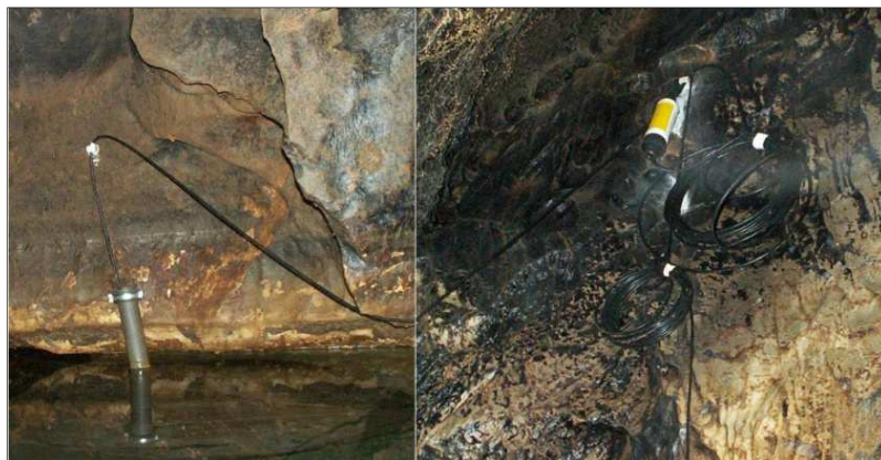
1. ábra: Mérési hely kialakítása az István-lápai-barlangban Fig.1: Datalogger in the István-lápai cave
