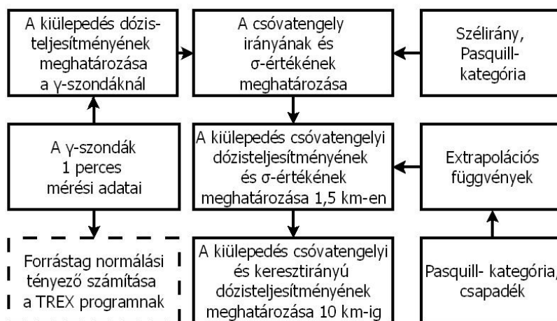
4. ábra. A kiülepedésből származó \gamma -dózisteljesítmény számítása 10 km-es távolságig
