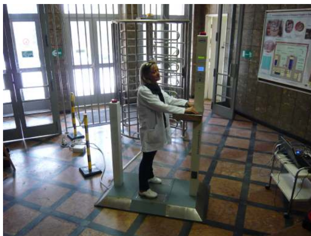
6. ábra. A főépületbe áttelepített sugárkapu
