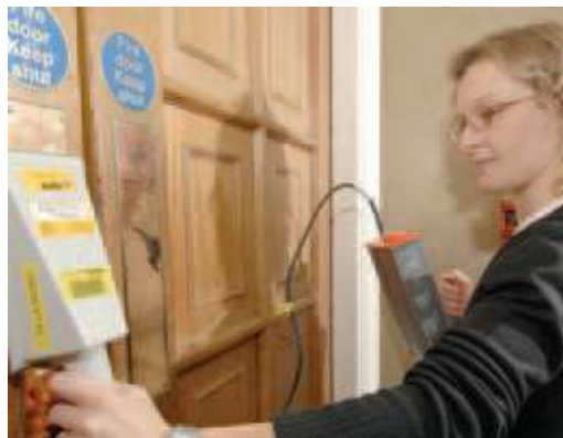
3. ábra: Felületi sugárszennyezettség-mérés (alfa) [11]
