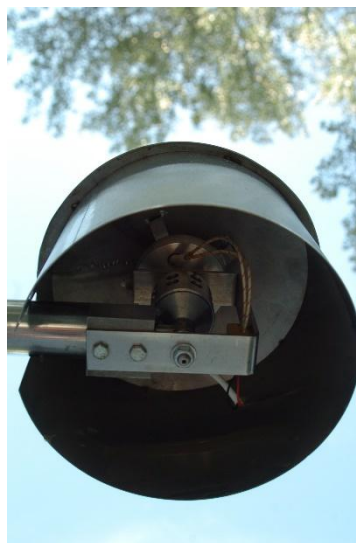
2. ábra. A mérőrendszerre jutó levegő páramentesítő, melegítő egysége. (Forrás: saját)
