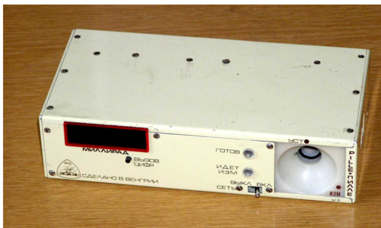
7. ábra. A dózismérő kulcsot a készülék jobb oldalán levő nyílásba kell behelyezni. (Fotó KFKI)
