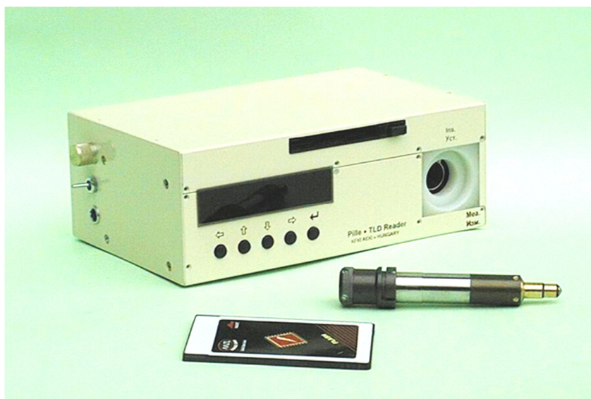
29. ábra. A mikroprocesszoros Pille második változata. (Fotó KFKI)
