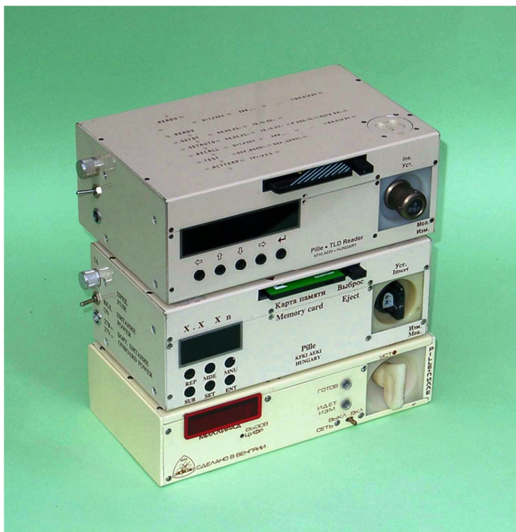
21. ábra. A mikroprocesszoros Pille, előtte balról a dózismérő, jobb oldalon a memóriakártya (Fotó KFKI)
