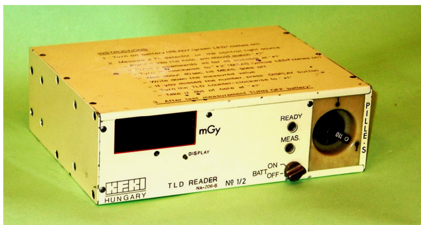
18. ábra. A Pille akkumulátoros változata. (Fotó KFKI)
