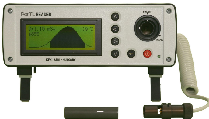
33. ábra. A PorTL dózismérő rendszer. (Fotó KFKI)
