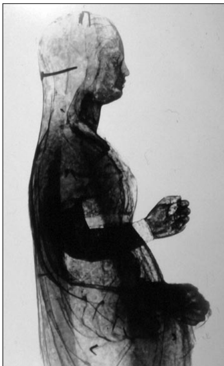
A röntgenfelvételen a szobor belsejében kialakított hosszanti üreg világos sávként látható The lengthwise hollow made in the inside of the sculpture can be seen as a light stripe in the radiogram
