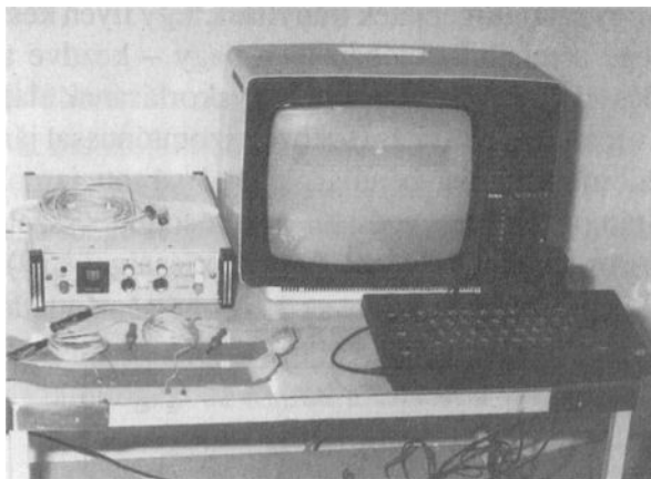
1. ábra: A TV előtt van a számítógép, alul a számítógép magnetofonja, balra a TV-től maga a MYO MODUL, rajta és előtte az elektródák.
