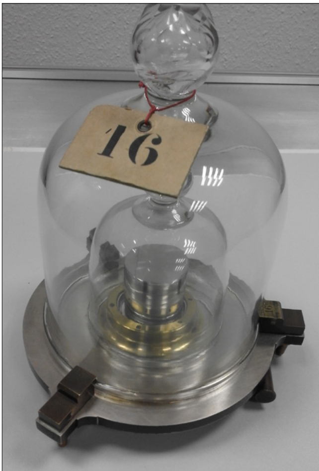
5. kép - Az 1889-ben sorsolás útján Magyarországnak jutott 16. sorszámú kilogrammetalon, mind a mai napig kettős üvegbúra alatt (Budapest Főváros Kormányhivatala Metrológiai és Műszaki Felügyeleti Főosztálya)
