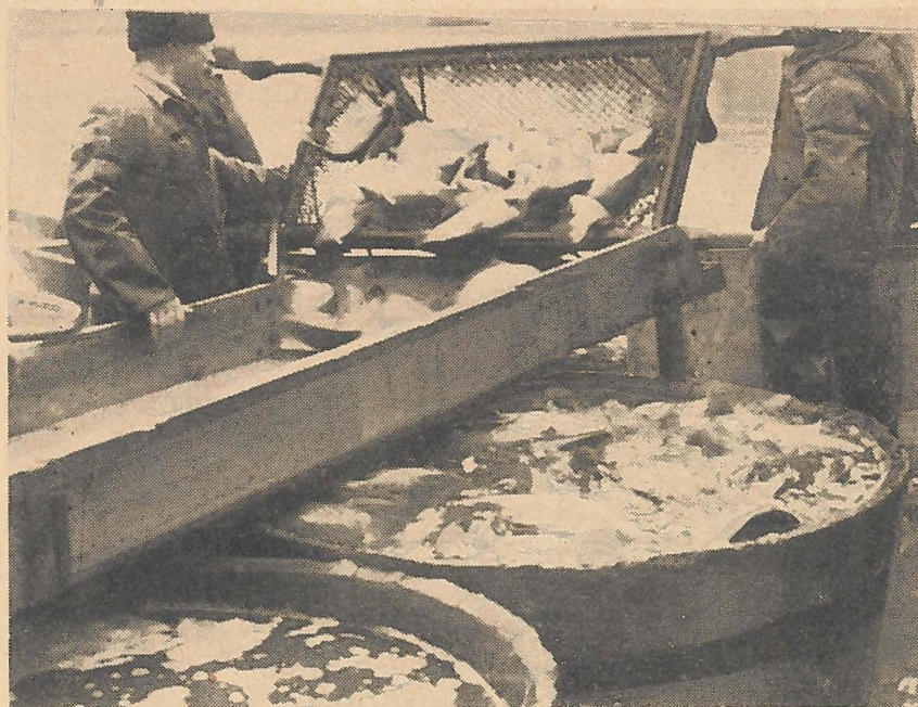
A hálhordó saroglya hosszának megfelelően kiszélesített kádakra helyezett válogatóasztal biztosítja a törődésmentes, gyors válogatást (Antalfy felv.)
