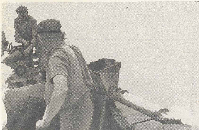
A trágyaszórógép üzemben: jobboldalt látható a garat és a szórólapon szétsugárzó trágyaszennyvíz. (Woynárovich dr. felv.)
