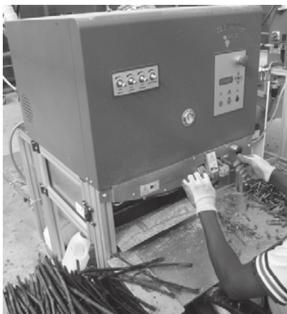
1. ÁBRA A Celerina Plus automata oltógép (saját forrás)
