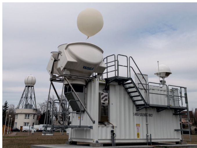
7. ábra. Az automata rádiószonda felbocsátó konténer a Marczell György Főobszervatóriumban (Kálmán Imre felvétele).
