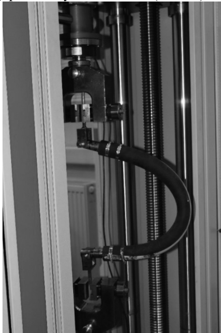
5. ábra. Kompozit tömlő 350 mm-es elmozdulásnál
