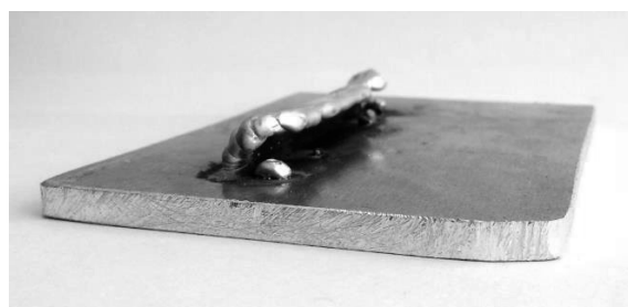
8. ábra Alaplappal párhuzamos varratsor felrakása
