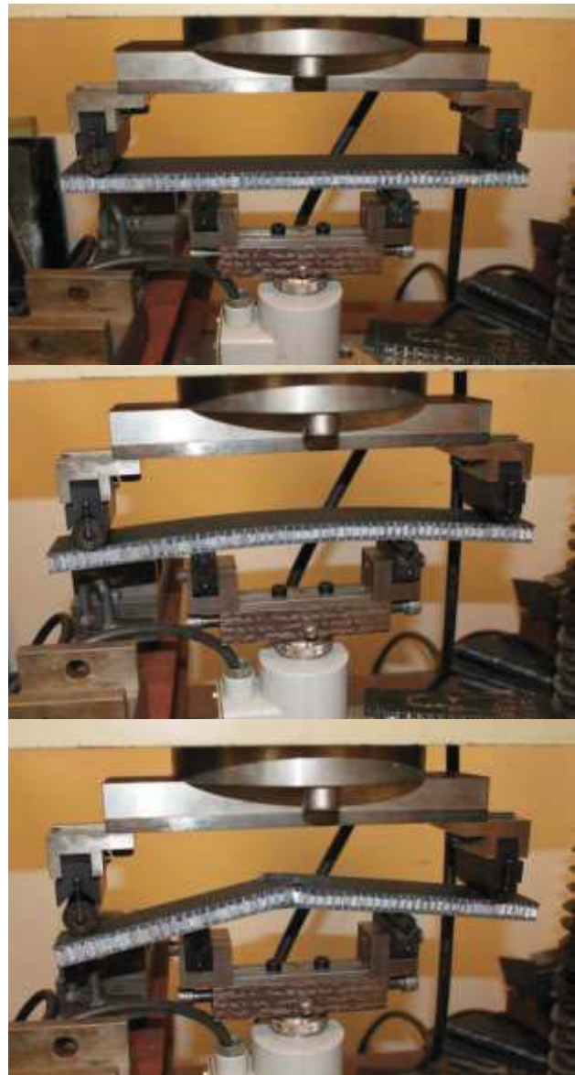
2. ábra - Próbatest konfiguráció a hajlítási teszthez
