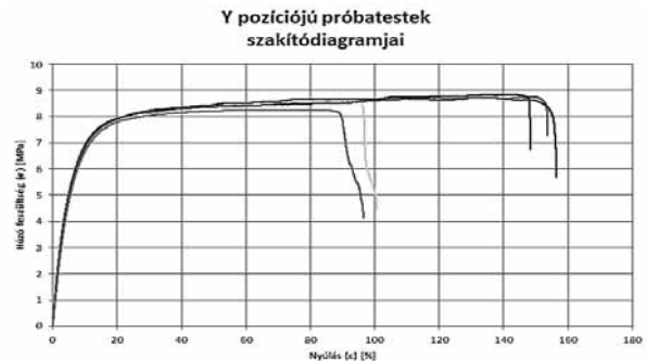
7. ábra: Y pozícióban nyomtatott próbatestek szakítódigramjai
