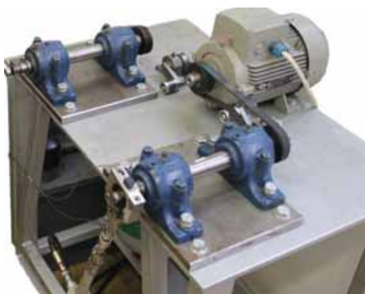
1. ábra. A csapágyvizsgáló berendezés
