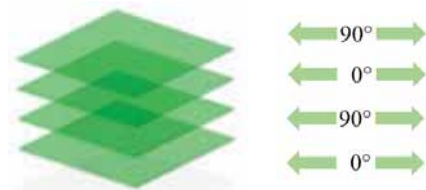
2. ábra Rétegek szálelrendezése a munkadarabban
