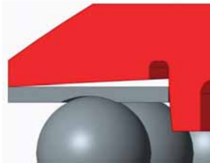
6. ábra: Hullámgenerátor bütyök és rugalmas csapágy érintkezése deformálatlan állapotban
