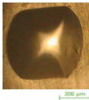
5. ábra. Mesterséges hiba a csapágyűrű futófelületén
