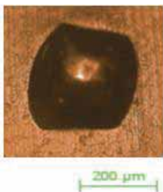
3. ábra. Mesterséges hiba a csapágyűrű futófelületén
