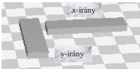
10. ábra: A nyomó rugalmassági modulus meghatározásához alkalmazott próbatetek nyomtatási pozíciói
