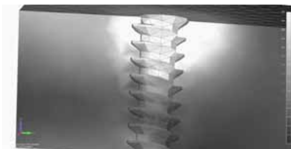
10. ábra. Feszültség eloszlás csontban, előfeszítéssel és elmozdulással terhelve
