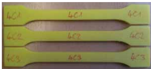
1. ábra. Az elkészült szabványos méretű próbatestek
