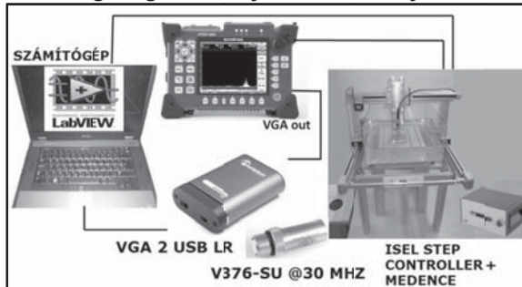
1. ábra. Automatizált vizsgálatra képes pásztaó akusztikus mikroszkóp
