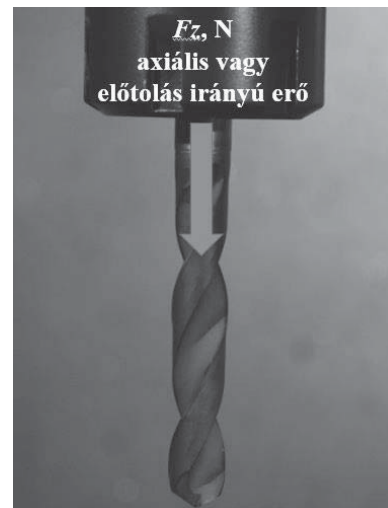
2. ábra. Ø 10 mm fúró CFRP anyagokhoz (DreamDrills – DI473100)
