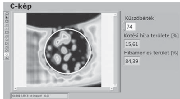
6. ábra. Hegesztési rétegből származó C-kép és a zárványok összterületének meghatározása
