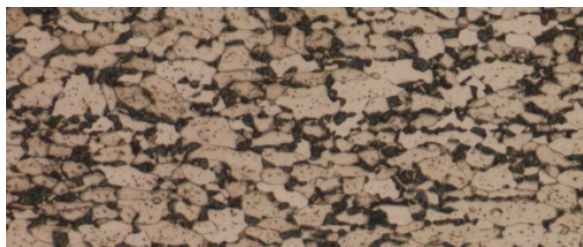
1. ábra. A DP 600-as acél ferrit-martensites mikrosziszolati képe. Nagyítás: 500x, Marószér: Nital
