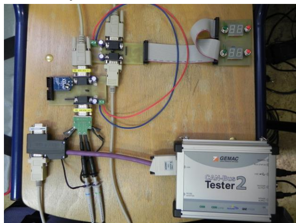
4. ábra – Az összeállított prototípus rendszer.
