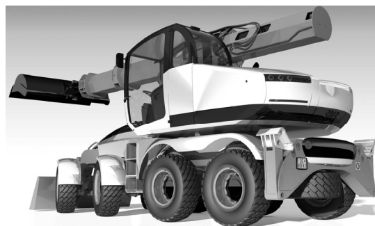
Fig.1 Telescopic excavator SUS Scrofa
