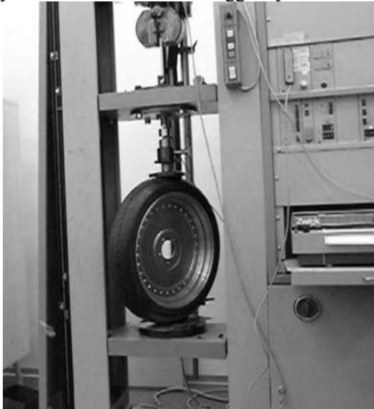
8. ábra. A függőleges rugóállandó mérése
