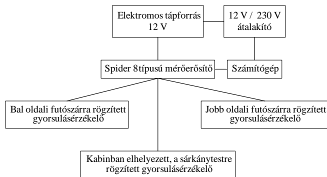
2. ábra Kisrepülőgépben ébredő gyorsulások mérésére alkalmas mérőrendszer vázlata
