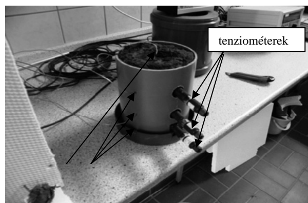
2. ábra. A hőmérséklet szenzorok és a tenziométerek elhelyezkedés a talajoszlopban
