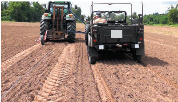
4. ábra. Szabadföldi vontatási vizsgálat
