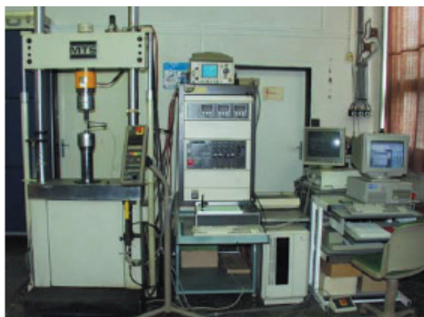
4. ábra. MTS 810 típusú univerzális anyagvizsgálógép
