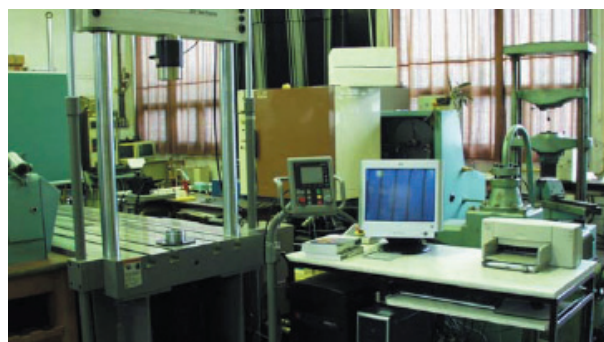
6. ábra. MTS 322 típusú, biaxiális szerkezetvizsgáló berendezés
