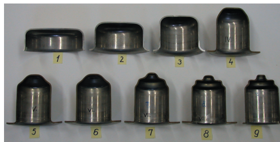
2. ábra. Ablaktörlő motorház sorozathúzó présen való gyártásának technológiai sorrendterve
