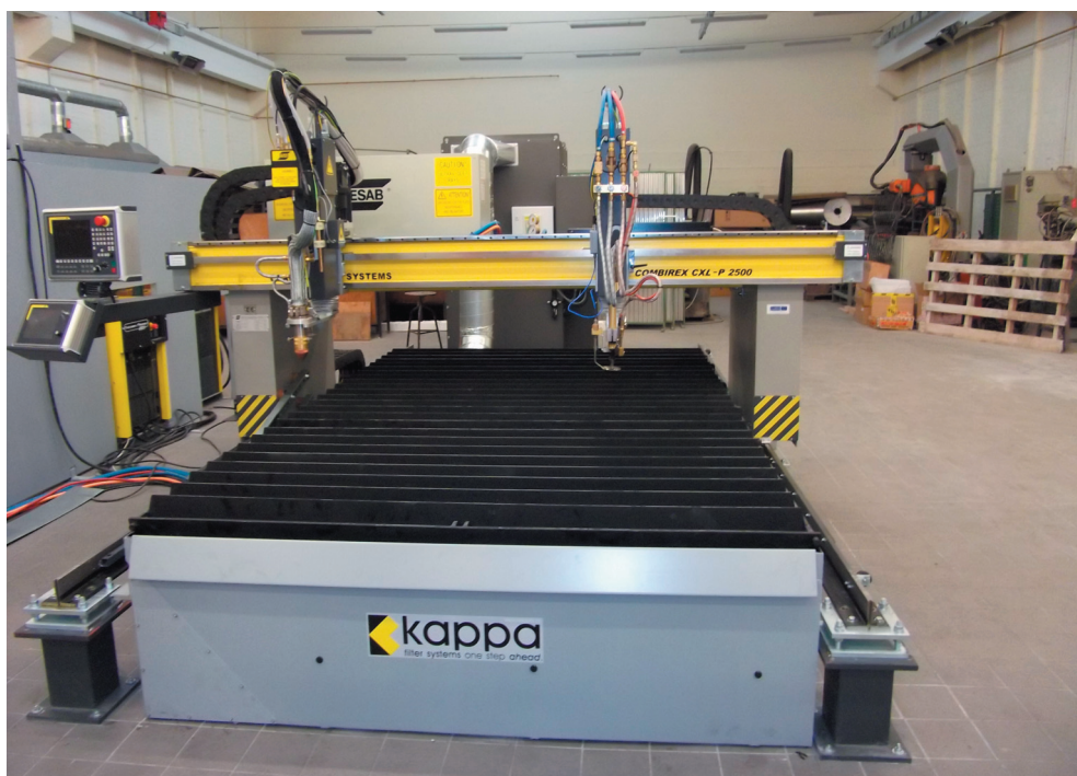
10. ábra. ESAB gyártmányú, CNC vezérlésű láng- és plazmavágó berendezés
