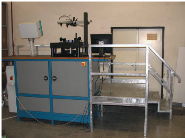
7. ábra. Optikai alakváltozás mérő rendszerrel felszerelt komplex lemezvizsgáló berendezés
