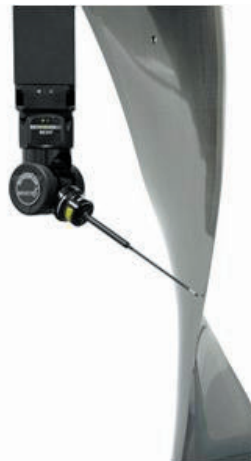
3. ábra. Renisaw mérőtapintó mérés közben.
