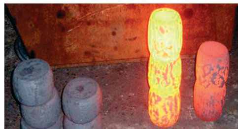
5. ábra. Üzemi körülmények között zömített kovácsdarabok.
