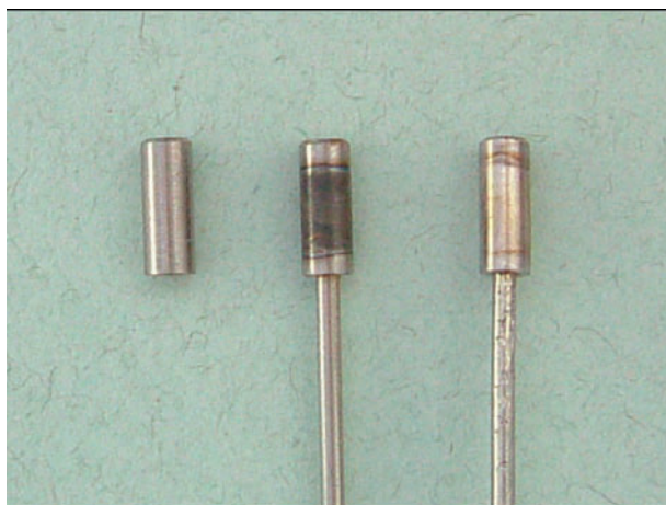
9. ábra A csap hegesztés előtt, védőgáz nélkül és Ar védőgázzal hegesztett munkadarab
