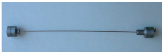
8. ábra. A szakító próbatest a felfűzött betétekkel
