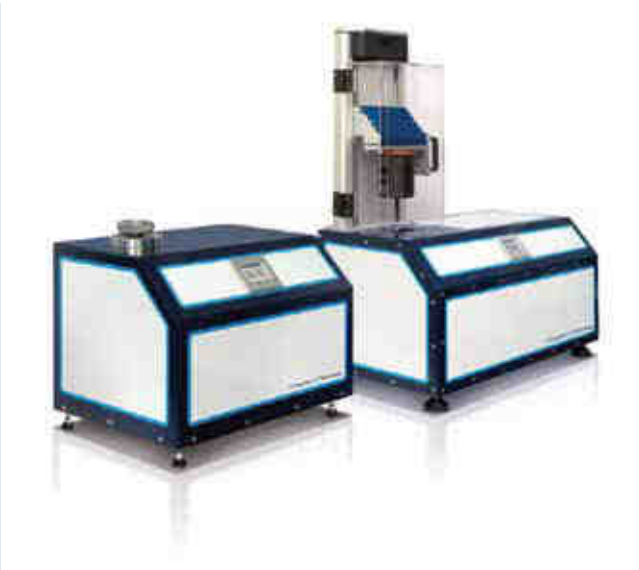
2. ÁBRA. A PTAT-előkezelés automatikus kivitelezésére szolgáló GBOX 2010 és 2140 készülék
