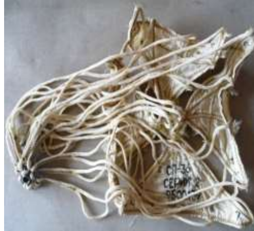
4. ábra SzP-36 típusú stabilizáló ejtőernyő 43 (A képen jól megfigyelhető a máltai kereszt-kialakítás, és a középszinórok alkalmazása.)
