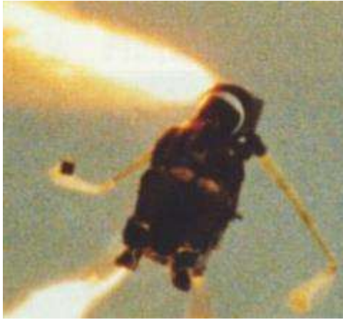
3. ábra A teleszkópos rudak kivágódása és a stabilizáló ejtőernyők légáramlatba kerülése a fülke elhagyása után 42
