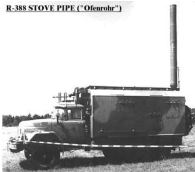
4. ábra. Az R-388 (NATO kód: STOVE PIPE) zavaró állomás telepített antennával. [7]
