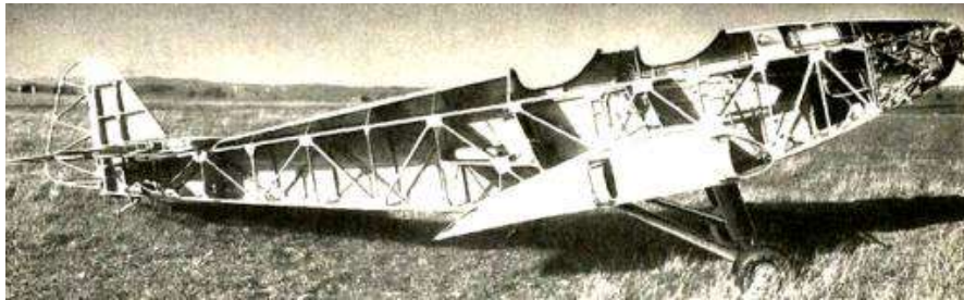
11. ábra Egy tipikusan fa szerkezetű gép metszete 13
