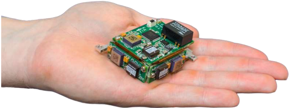
6. ábra A brit OXTS „xOEMcore” IMU-ja (Fotó: OXTS)
