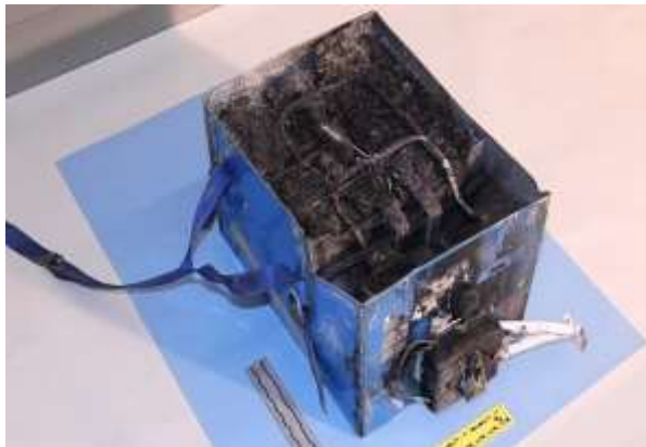
10. ábra B-787 felrobbant Li-Ion akkumulátora 14
