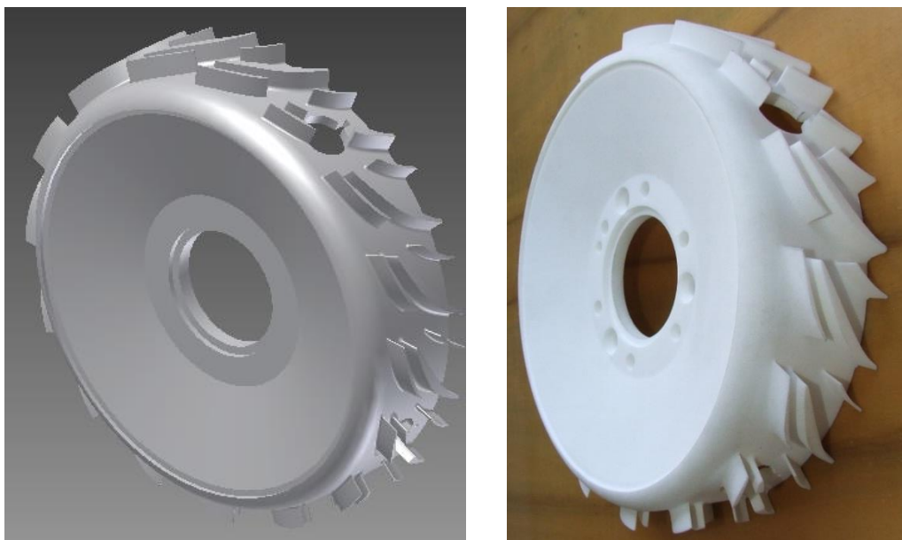
14. ábra Az új diffúzor lapátozás látványterve és a kivitelezett példány
