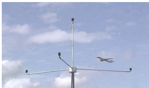
5. ábra. A mikrofonok egy 3D irány meghatározásra alkalmas állomáson 8
