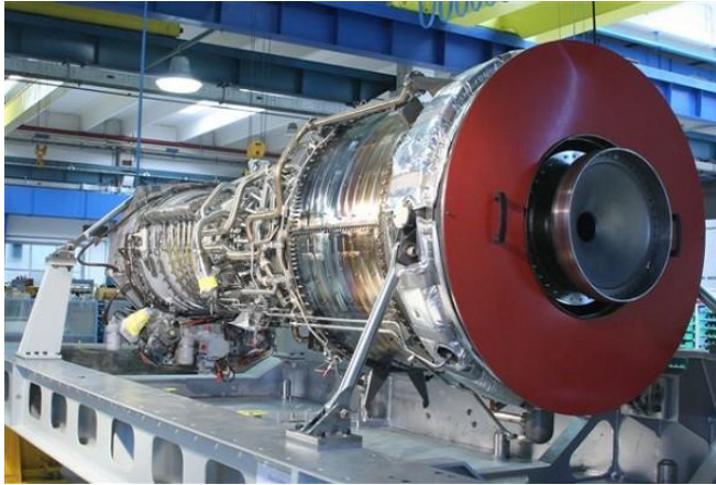
4. ábra Két GE LM 2500-as gázturbina képezi a fenti 127 m hosszú US Partiőrség hajójának erőforrását [4]
