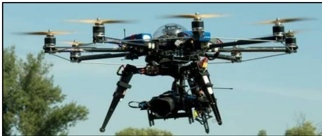
1. ábra Oktokopter a légi fotózáshoz szükséges kamerával 5
