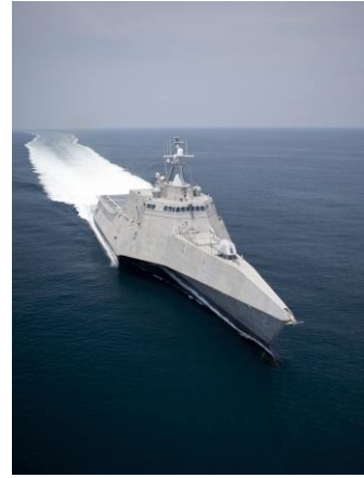
4. ábra Két GE LM 2500-as gázturbina képezi a fenti 127 m hosszú US Partiőrség hajójának erőforrását [4]
