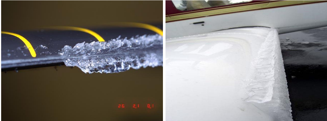
1. ábra A tiszta jegesedés tipikus megjelenési formái 3
